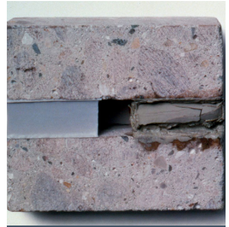
在各种风化、加热和稳定性测试中暴露在潮湿和紫外线环境中2500小时后的DOWSIL™硅酮密封胶(左)和一种领先的聚氨酯密封胶
